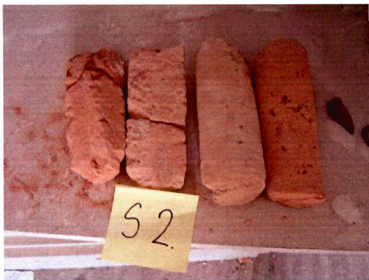
Bild 10: Bohrkern aus dem Mauerwerkspfeiler S2
