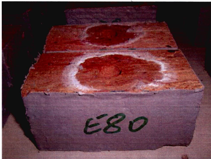
Bild 13: Injektionsmittelverteilung im Versuchsziegel
