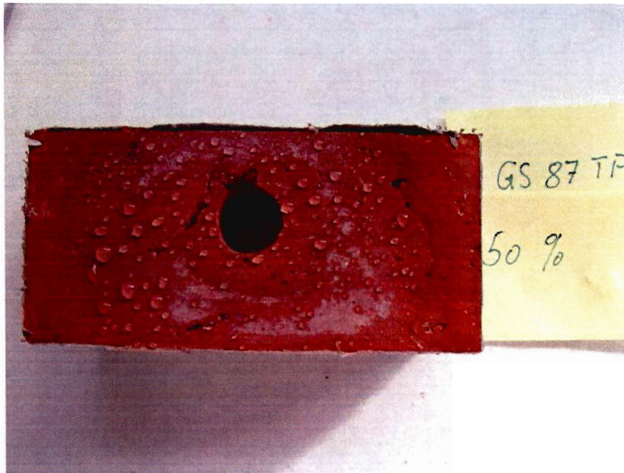
Bild 14: Injektionsmittelverteilung im Versuchsziegel
